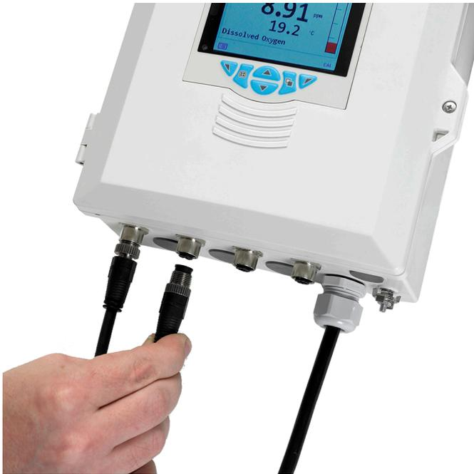
Abbildung 4 EZLink-Sensoranschluss
